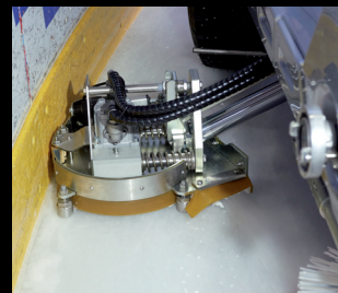
Fresabordi in acciaio zincato, regolabile elettronicamente in altezza
