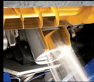
Impianto lavaggio coclea verticale
