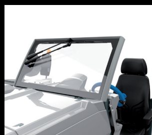
Parabrezza in vero vetro con sistema tergicristallo
