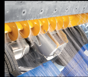
Impianto lavaggio coclea orizzontale
