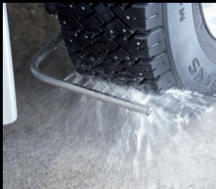
Pyörien pesulaitteisto, ohjautuva
