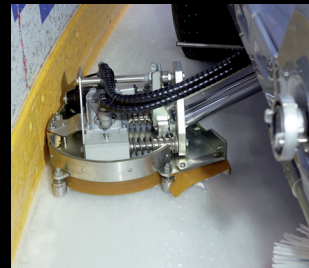
Bandenfräser aus verzinktem Stahl, elektronisch höhenverstellbar
