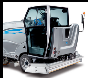
Prosklená panoramatická kabina
