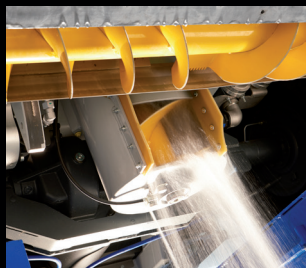
Oplach vertikálního šnekového dopravníku
