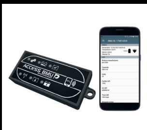
Access BMU Monitoring nabíjení baterie
