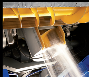
Impianto lavaggio coclea verticale
