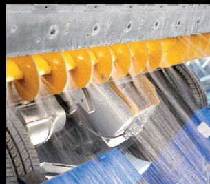
Oplach horizontálního šnekového dopravníku
