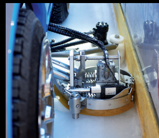
Kantfräs Rostfritt stål, skärdjup inställbart från förarplats
