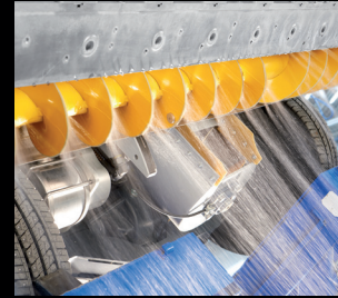
Kierukan pesulaitteisto vaakasuora
