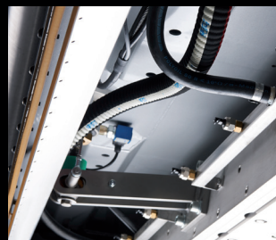
Systém mytí ledu (Multijet) Multivstříkování se systémem odsávání vody
