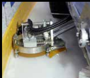
Бортовой фрезер Электронная регулировка по высоте
