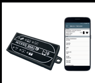
Доступ к BMU Блок Контроля Батареи
