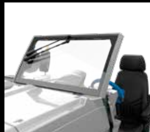
Windschutzscheibe aus Echtglas mit Scheiben- wischanlage
