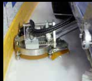
Bandenfräser aus verzinktem Stahl, elektronisch höhenverstellbar
