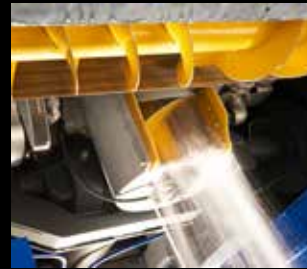
Impianto lavaggio coclea verticale
