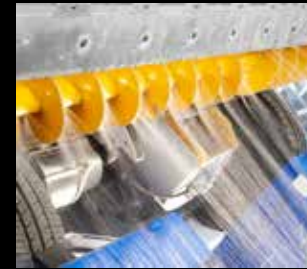
Impianto lavaggio coclea orizzontale
