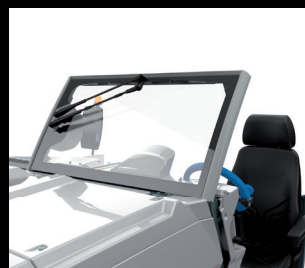
Parabrezza in vero vetro con sistema tergicristallo
