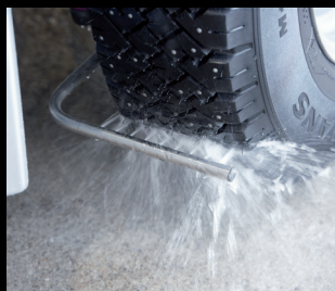
Impianto lavaggio ruote svolta dinamica
