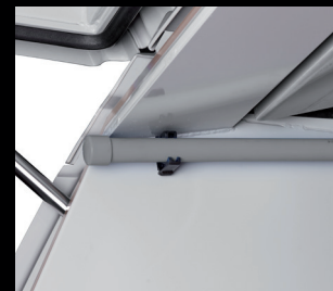
Impianto lavaggio serbatoio neve
