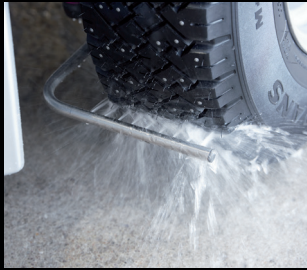
Pyörien pesulaitteisto, ohjautuva
