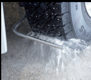
Dynamicky řízený systém mytí kol
