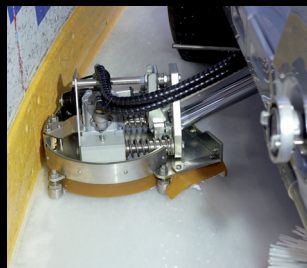
Boční fréza Elektricky nastavitelná výška
