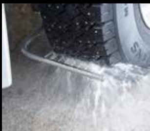
Système de lavage roues virage dynamique
