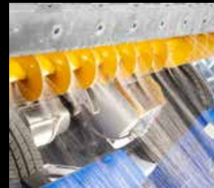
Kierukan pesulaitteisto vaakasuora
