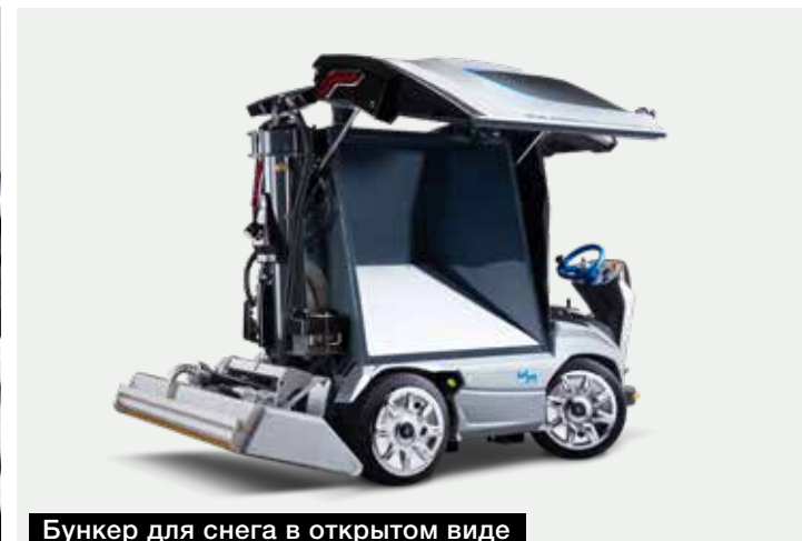
Бункер для снега в открытом виде
