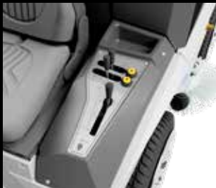
Hydraulinen terän säätö
