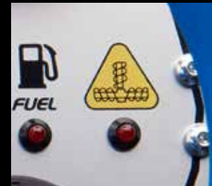
Ruuvikuljettimen ylikuormituksen varoitusjärjestelmä
