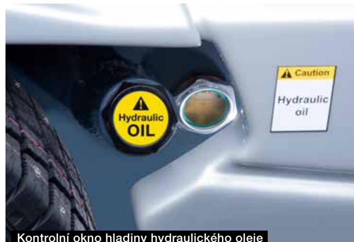
Kontrolní okno hladiny hydraulického oleje
