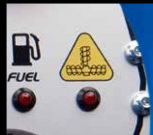
Výstražný systém přetížení dopravníků
