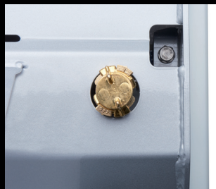
Mycí systém pro horizontální šnekový dopravník
