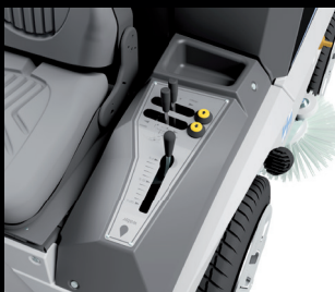
Hydraulické nastavení nože
