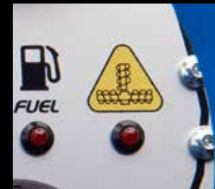
Système d'alarme surcharge des vis sans fin
