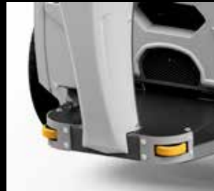
Tôle de protection pour les galets de guidage
