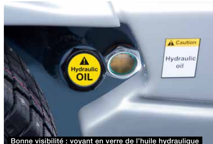
Bonne visibilité : voyant en verre de l'huile hydraulique
