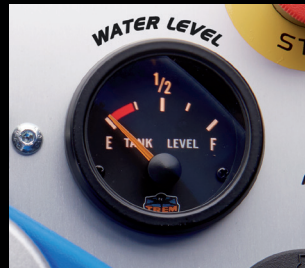
Indicateur de niveau d'eau
