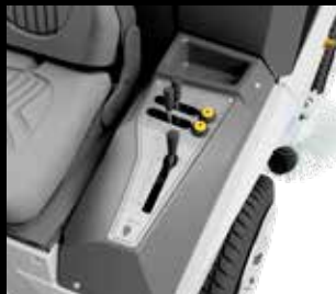
Réglage hydraulique des lames
