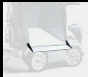
Rallonge de la rampe de glisse
