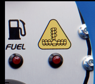
Warnsystem Überlastung Förderschnecken
