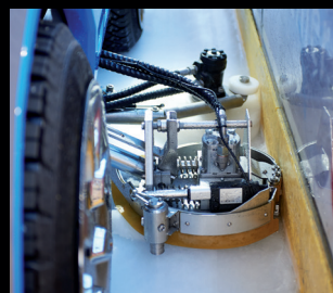
Бортовой фрезер из нержавеющей стали с электронной регулировкой по высоте
