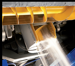
Система мойки вертикального винтового транспортера (шнека)
