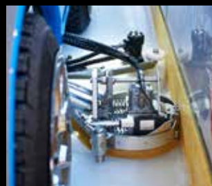
Kantfräs Rostfritt stål, skärdjup inställbart från förarplats
