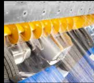
Wasinstallatie horizontale schroef
