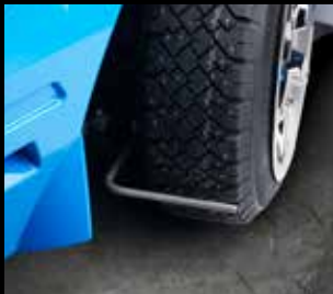
Pyörien pesulaitteisto, ohjautuva
