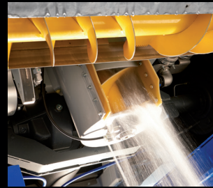
Kierukan pesulaitteisto pystysuora
