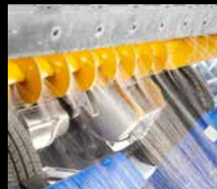
Système de lavage vis sans fin horizontale
