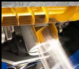
Système de lavage vis sans fin verticale
