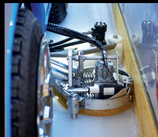
Coupe-bordures en acier inoxydable, réglable électroniquement en hauteur
