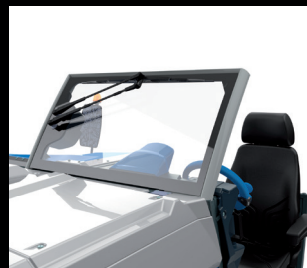
Pare-brise en verre véritable avec système d'essuyage
