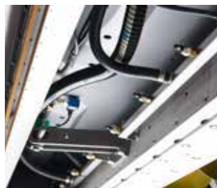
Eiswaschanlage Multijet mit Absaugleiste
