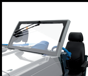
带雨刮器的真玻璃材质挡风玻璃
