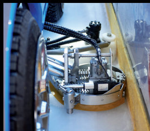
扫边机 不锈钢, 电动调整高度
