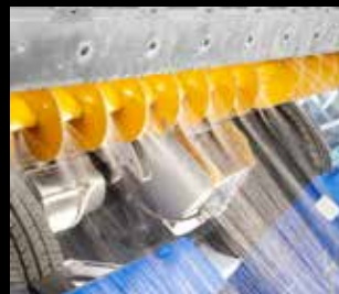
Oplach vertikálního šnekového dopravníku
