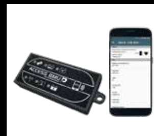
Access BMU monitorovací jednotka baterie
