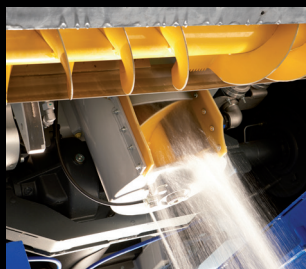
Oplach horizontálního šnekového dopravníku
