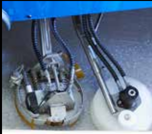
Kantfräs Rostfritt stål, skärdjup inställbart från förarplats
