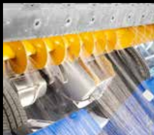
Система промывки горизонтальных винтовых транспортеров
