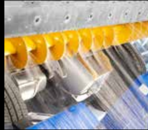
Impianto lavaggio coclea orizzontale
