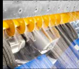
Kierukan pesulaitteisto vaakasuora
