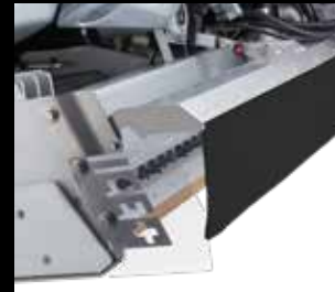
ICEplus Flexi Wassersprühsystem + automatischer Wischtuchheber
