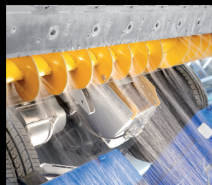
Impianto lavaggio coclea orizzontale
