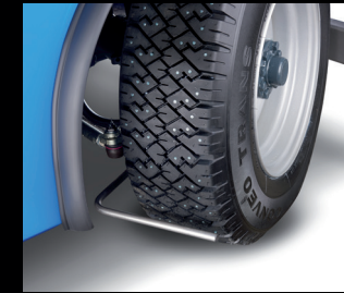
Pyörien pesulaitteisto, ohjautuva
