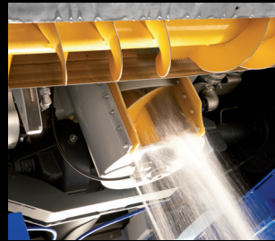
Kierukan pesulaitteisto pystysuora
