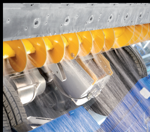
Oplach horizontálního šnekového dopravníku
