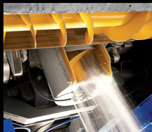
Oplach vertikálního šnekového dopravníku
