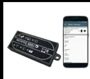
Доступ к ВМУ Блок Контроля Батареи
