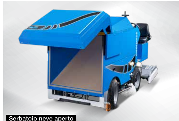
Serbatoio neve aperto
