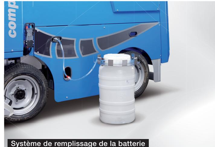
Système de remplissage de la batterie
